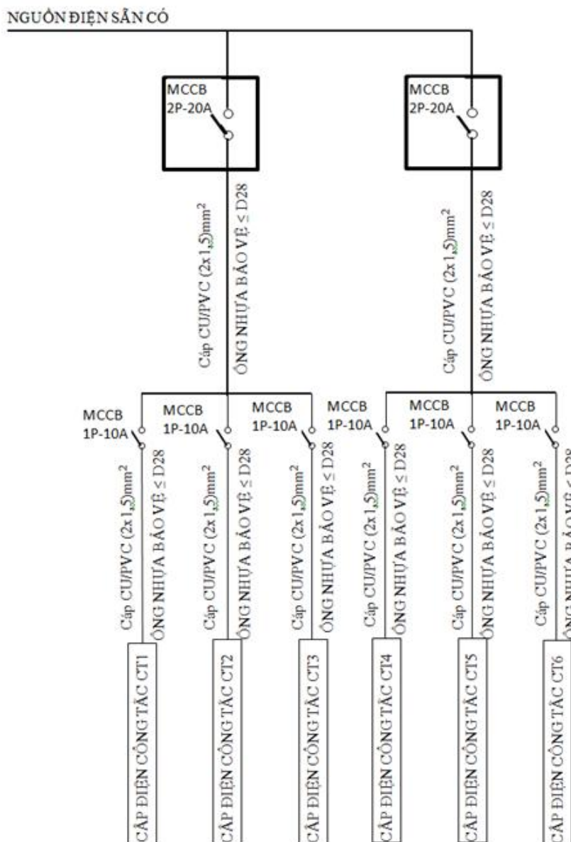
Hình 14. Sơ đồ một sợi cáp điện cho hệ thống đèn phòng CD06
