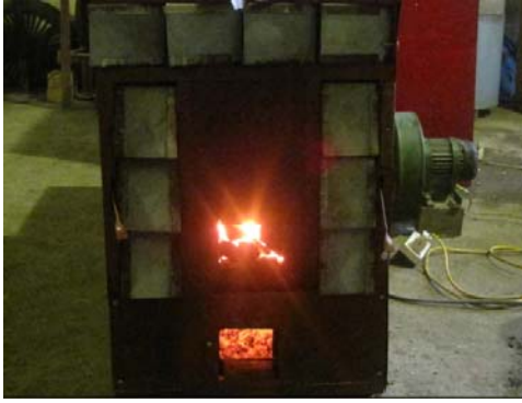
Hình 13. Quá trình cháy nhiên liệu trong buồng đốt của lò LD 1,0
