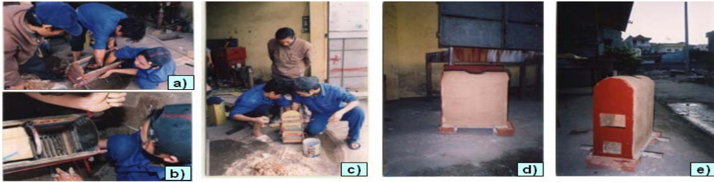
Hình 10. Các nguyên công, công đoạn gia công ruột lò (Tùng và cs., 2005)
