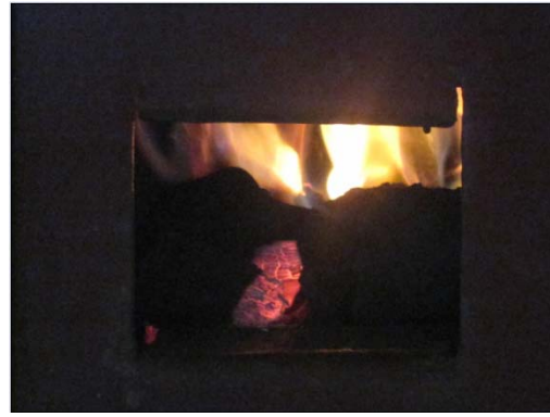
Hình 13. Quá trình cháy nhiên liệu trong buồng đốt của lò LD 1,0
