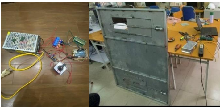
Hình 18. Khảo nghiệm riêng từng cánh cửa thùng sấy trước khi tích hợp trên tổng thể máy sấy
