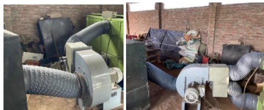
Hình 14. Bộ cấp gió sau khi chế tạo
