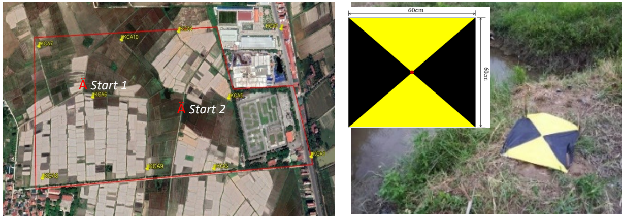
Hình 5. Vị trí các điểm GCPs, điểm cất cánh và tiêu khống chế ảnh
