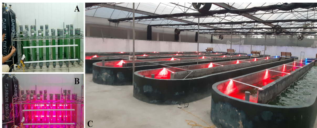
Ghi chú: Tảo giống nuôi trong ống thủy tinh đường kính 70 mm, chiều cao 600 mm với ánh sáng huỳnh quang (A) và đèn LED (B) trong phòng thí nghiệm. Chiếu bổ sung đèn LED ở bể raceway trong nhà lưới vào vụ đông xuân (C).
