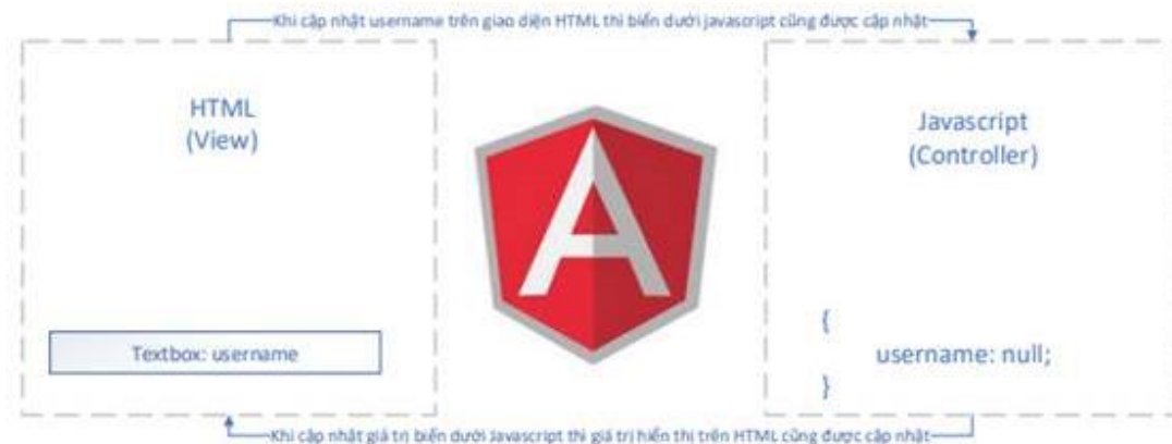
Hình 4. Cơ chế two-way binding của AngularJS
