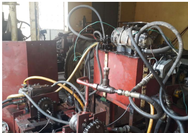
Hình 3. Bộ thử công suất để thí nghiệm HSPNCS
