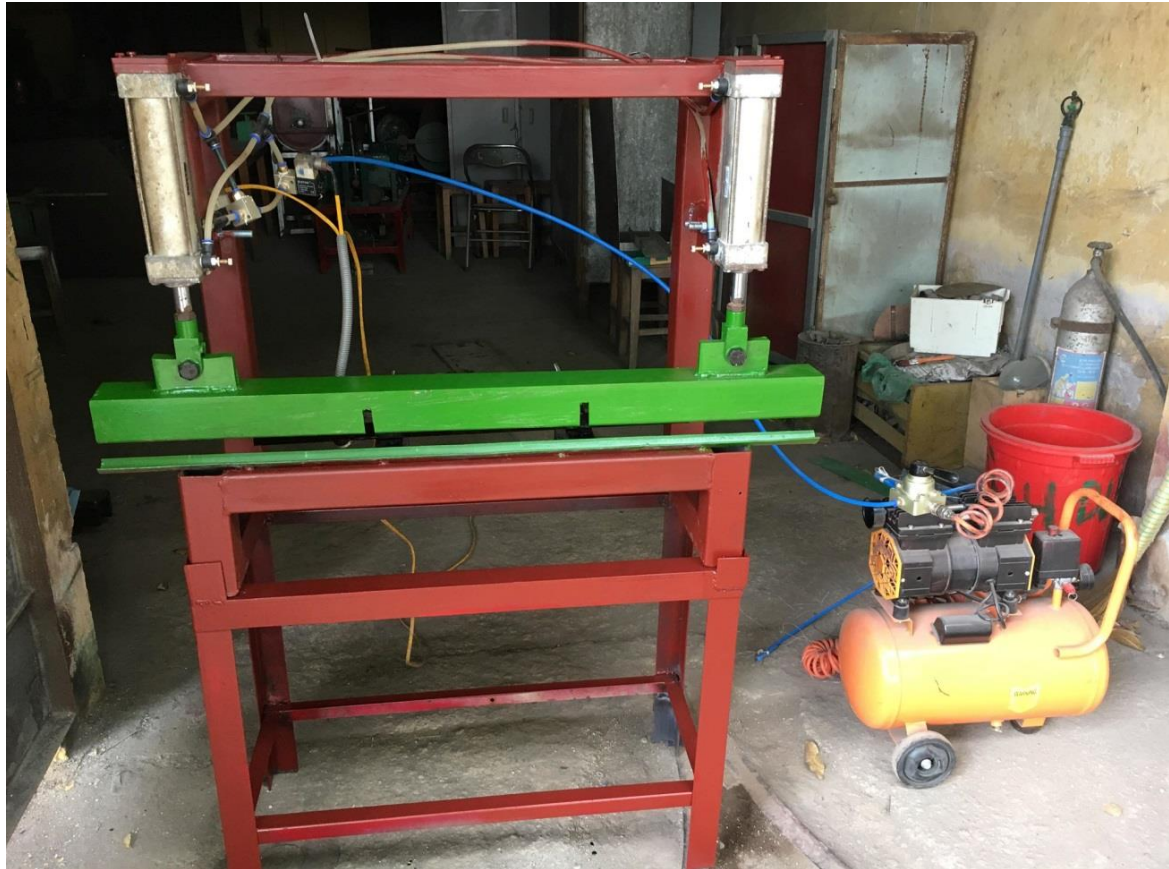
Hình 11. Hình ảnh máy uốn gấp được chế tạo
