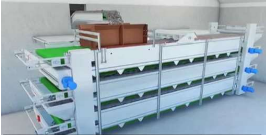
Hình 3. Hệ thống sấy phân gia cầm kiểu băng tải
