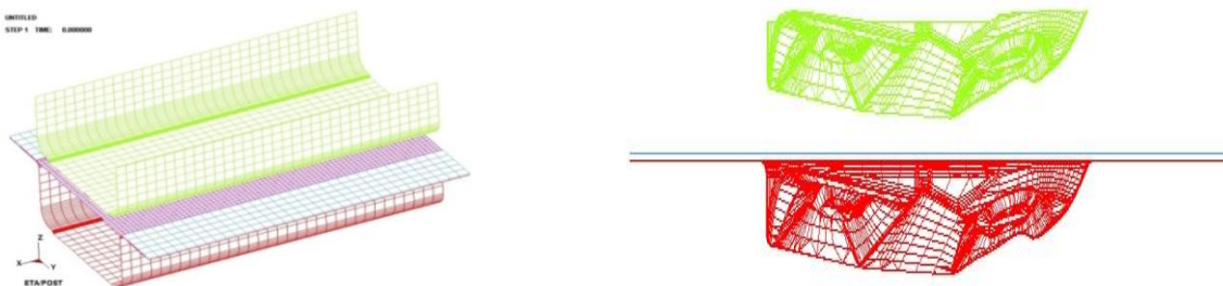
Hình 10. Mô hình chia lưới các phần tử khi dập nắp ca pô máy kéo V22
